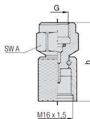
Manometeranschluss für Direktanschluss SMD15
