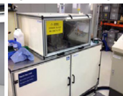
Impulsdruck-Prüfstand bis zu 4.000 bar
