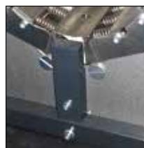
Optionale Sonderausrüstung für Industriepressen ab HM 3xx Kraftmesssystem zur Erfassung der aktuellen Umformkräfte direkt an der Grundbacke. Ein oder mehrere Kraftsensoren axial über Grundbacke verbaut. Mit mehreren Sensoren kann der Kraftverlauf über die Grundbackenlänge erfasst und ausgewertet werden.
