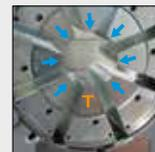
Die feststehende 6-Uhr-Backe ermöglicht das sichere und kraftsparende Positionieren des Werkstückes.
