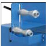
Seitliche Führungsrollen zum einfachen Einspannen und Fixieren des Schlauches, für bessere Schnittqualität. (EM 115)
