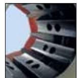
Mit Hilfe der zwei Positionsbohrungen in den Grundbacken lassen sich Verpressungen an Vorder- und Rückseite durchführen.
