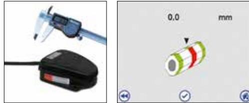
Messpunktmenü inkl. Fußmaus/Messschieber (3 Zoll oder 4 Zoll): Qualitätsprüfung via Messschieber und Fußmaus (als OK Taste). Mit dem digitalen Messschieber können Sie die Pressmaße ebenfalls auf Konizität und Ovalität prüfen (Messpunktanzahl). Die Piktogrammgeführte Menüsteuerung leitet Sie durch den gesamten Prozess.
