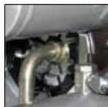
Die S 3-Serie verpresst selbst kurze 90°-Armaturen mit langem Endstück. Dies ist mit keiner anderen konventionellen Maschine möglich.
