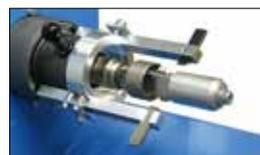
Gleichzeitiges Innen- und Außenschälen möglich (USM 100)
