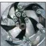
Verbesserte zentrierte Schlauchklemmvorrichtung mit längeren, geriffelten Halterollen, die einen besseren Griff gewährleisten.
