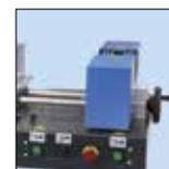
Axial verstellbare Spanneinheit verhindert das Knicken kleiner Schlauch-nennweiten.
