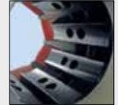
Mit dem neuen Zwei-Loch-System wird das Einsetzen der Pressbacken von beiden Seiten vereinfacht und die Möglichkeit geboten, pro Seite zwei unterschiedliche Positionierungen zu wählen, passend zum jeweiligen Pressbackentyp. Die HM 3 H ist kompakt und bietet eine gute Zugänglichkeit.
