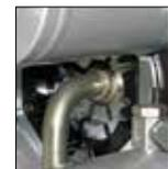
Die S 4-Serie verpresst selbst kurze 90°-Armaturen mit langem Endstück. Dies ist mit keiner anderen konventionellen Maschine möglich.
