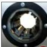
Der große Öffnungsweg ermöglicht das Durchführen von 90°-Armaturtypen ohne das Wechseln der Pressbacken.
