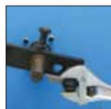
Messereinstellung für die Schälentiefe nur einmal notwendig für jeden Schlauchdurchmesser bei der USM 10 S.
