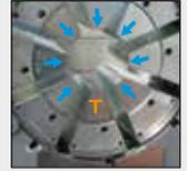
Der feststehende 6-Uhr-Backen ermöglicht das sichere und kraftsparende Positionieren des Werkstückes.
