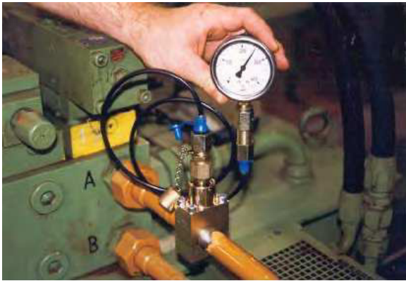
Montage unter Druck mit Serv-Clip ® -1
