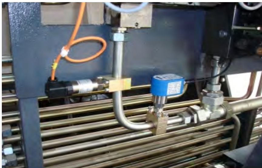
Abbildung 2: Rohrmessanschluss Serv-Clip ® -1 mit Drucksensor—Gewindeanschluss G 1/4"
