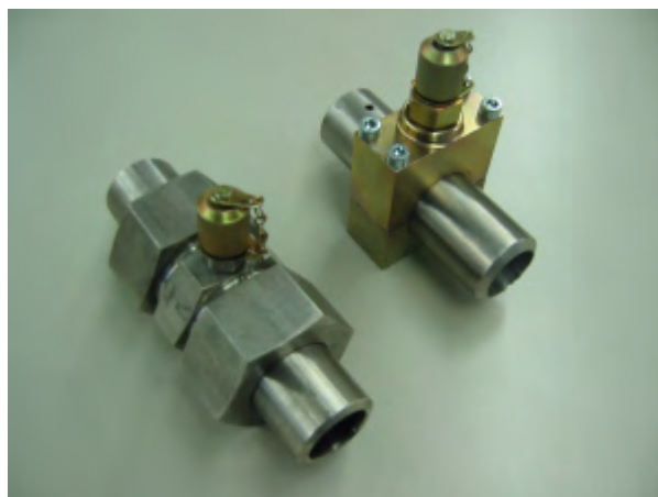
Abbildung 7: Einbauvergleich: Konventionelle G-Verschraubung mit Messanschluss und Serv-Clip®-2 der Rohrmessanschluss ohne Rohrtrennung
