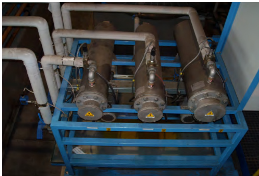
Abbildung 1: Druckmessung an einer Durchlaufheizlinie für Einfettöle mit Serv-Clip ® -1 und Drucksensor DS-1-A-400-1/4"
