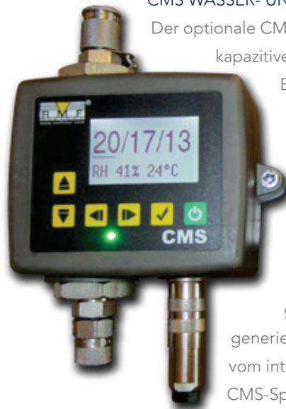
Der optionale CMS Wassersensor misst den Wassergehalt mit einem kapazitiven rF/RH-Sensor (relative Feuchte/relative humidity). Das Ergebnis wird als prozentuale Sättigung ausgedrückt. 100 % rF/RH entspricht dabei dem Punkt, ab dem freies Wasser in der vorhandenen Flüssigkeit enthalten sein wird, d.h. das Öl kann ab diesem Punkt kein weiteres Wasser mehr aufnehmen.
