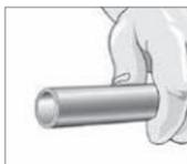
5. Hülse muß mit Rohrende bündig abschließen.
