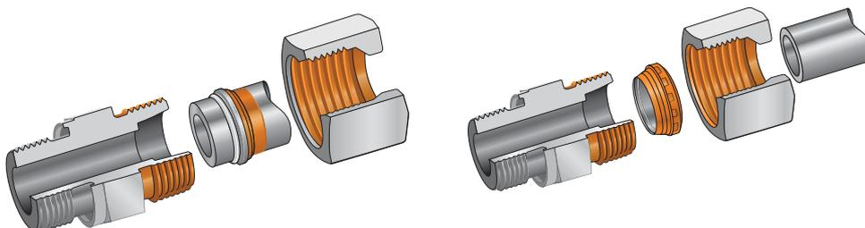
Vor der Montage sind die Verschraubungen gründlich zu reinigen und alle Kontaktflächen mit einem Pinsel oder nicht fasernden Lappen, in ausreichender Menge, mit Anti-Block-Fett einzustreichen. Nach dem Fetten sind die Verschraubungen direkt zu montieren, um Verunreinigungen zu verhindern. Montageanleitungen der jeweiligen Verschraubungssysteme beachten.
