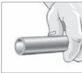
5. Hülse muß mit Rohrende bündig abschließen.
