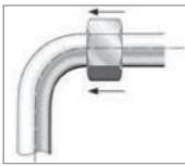
4. Überwurfmutter auf das Rohr schieben.
