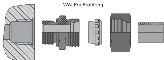
Verschraubungsteile entsprechend DIN 2353 / DIN EN ISO 8434-1
