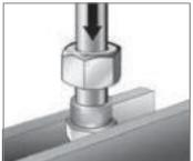
**Achtung:** Bei ungünstigen Montagebedingungen und bei großen Rohrabmessungen ist die Direktmontage im Schraubstock durchzuführen. Hierfür denselben Verschraubungsstutzen wie für den Einbau verwenden.
