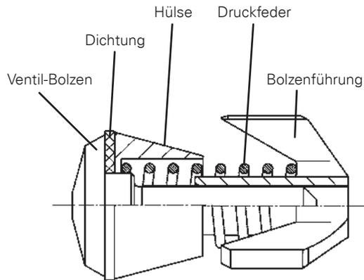
Der Ventileinsatz der Nennweite 16 kann beim Einbau nicht umgekehrt eingesetzt werden.
