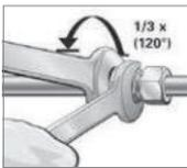
7. Fertigmontage im Verschraubungsstutzen
