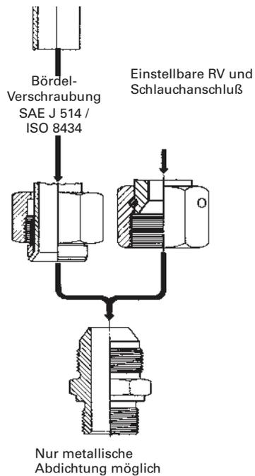
Eaton Walterscheid-Bördel-Verschraubung (DIN 3949) im Vergleich zur Bördelverschraubung nach SAE J 514/ISO 8434
