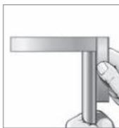
2. Rohr rechtwinklig abtrennen (keinen Rohrabschneider verwenden). Rohrenden innen und außen leicht entgraten. Nicht anfasen! Reinigen.
