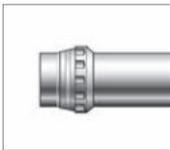
4. Mit Hammer (Hartgummi oder Kunststoff) ganz einschlagen. Rändelung wird in die Innenwand des Rohres eingedrückt und sichert die Hülse gegen Verschieben oder Herausfallen.
