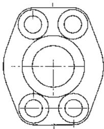
Die äußeren Abmessungen, der Abstand der Bohrungen zueinander (Lochbild) und die Anschlußmaße der Flansche entsprechen der SAE J 518 und der ISO 6162:1994 (E).
