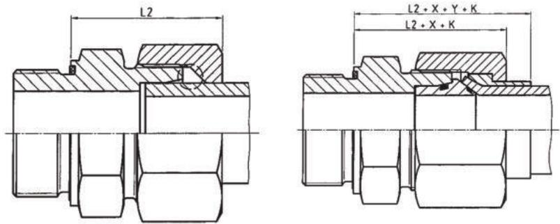
Beispiel: GES 15 LM-WD mit Rohr 15x2 Korrekturwert = +1
